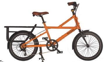
＜評価点＞荷物の運搬性能が高く重心の低い自転車である。機能を吟味しながら、愛着の持てるていねいな設計で、自転車の多様性の裾野を説得力をもって押し広げている。自転車が垂直に立つスタンドの型式も、荷を取り扱いやすい自転車の角度を想定したもので、乗ったままでも操作できる操作性も含めて高く評価できる。斜めに傾くスタンド型式だとハンドルも傾斜方向に傾ぎ、自転車の駐輪効率を微妙に妨げる。運搬性能と同時にこのような自転車本来の使いやすさを見直す視点をも評価したい。
