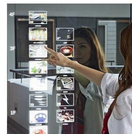
ミラー効果を持ちながら、タッチセンサー等各種センサー技術との融合を実現した特殊ガラス。従来のハーフミラーやマジックミラーにはないインタラクティブ性を最先端技術により盛り込んでおり、光の透過損失を最小限に抑えることで、高い映像クオリティを確保。
