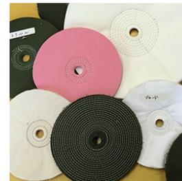
バフホイールは産業用の研磨に使われる道具で、主に布やフェルト素材で作られている。磨く対象物の素材や使う職人によってバフホイールの素材や製造方法を変える多品種少量生産に対応しており、薄手から厚手まで種類豊富な素材のストックを持つ。
