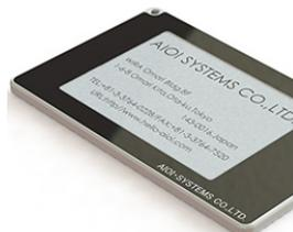
表示機能付き薄型RFID(※)タグ。ICチップに書き込まれたデータがカード本体に表示され、ネットワーク上で様々な情報を共有できる。省電力設計かつ非接触給電方式を採用しているため、生産現場での電子かんばん、物流現場でのコンテナタグ、回転寿司店での精算伝票などとして使用されている。
