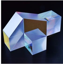
産業・医療用の光学機器に組み込まれるガラス類の部品を製造してきたカドミ光学工業(株)による、高度な精密接合加工技術。単純な形状のガラスプレート以外にも、ミラーやレンズ、プリズムなど、様々な機能や形状の素材を扱うノウハウが豊富。特に素材の磨かれた面同士を接合する技術には定評があり、中でも接着剤を使用しない「オプティカルコンタクト方式」は接合した面が目視ではわからないほどの精巧さで美しい仕上がりを実現できる。
