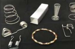
電子機器、医療機器などに使用される線径の細い細精密ばねの製造で培ってきた技術。材料は、ステンレス、鉄、銅合金、プラチナなどの金属線を使用した加工を得意とする。線径φ0.035mm～φ4.0mm程度の加工が可能で、螺旋状に巻かれた一般的な圧縮コイルばねと呼ばれる円筒型のばねの他にも、三角形、四角形など、多角形のユニークな形状のばねを製作することができる。
