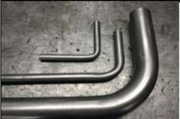
筑波鉄工株式会社は60年以上培った技術により鉄、銅、ステンレスなど様々な金属素材をφ15mm～φ114.3mmまで切断、曲げ加工、溶接、塗装まで一貫して請け負える。また、パイプに穴をあけたり、Rカット、斜め切断加工、形状もひねりの工程を入れる事で、三次元に曲げる事も可能となり、多様なニーズに合った製品を曲げと溶接技術で作り出すことができる。
