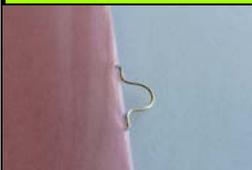
アイレット中綴じとは、冊子の製本時によく使用されている中綴じに吊るす機能を加えたもので、針金をΩ型にする製本方法。専用の針金加工の装置を中綴じ機に取り付けることで、通常の生産ラインでアイレット中綴じを施せる。針金を打つ間隔を調整することで、1冊の冊子に複数アイレット中綴じを施すことも可能。バインダーに通すための穴をあけずに済み、絵柄・文字などが欠落することもなく、冊子本来のデザインを活かすことも可能。
