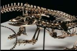
銀鏡塗装技術は全ての工程をスプレーガンで行い、通常塗装では表現できない光沢のあるメッキ面を形成する。意匠性を向上させることに特化した塗装技術。対応素材は専用の下地を塗布できること、50℃以下で素材が変形・溶解しないこと。この2点が満たせば、どのような素材、形状に対しても銀メッキ処理が行える。発泡スチロール、金属、プラスチック、3Dプリンタ出力物、木、ガラス、カーボンなどの素材にもメッキ処理ができ、色彩表現も多彩。
