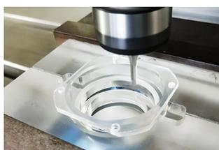
マシニングセンターを使用し、アクリル樹脂を精密に美しく加工(切削・接着・研磨)する技術とともに、バフ研磨、サンドブラスト、塗装など表面仕上げ技術に関し、長年積み重ねてきた経験とノウハウがある。また、ステンレスなどの精密金属加工技術、用途に応じた最適なLED光源の開発など、高い意匠性が求められるビルやホテルなどの特注型エレベーターの意匠器具(ホールボタン、表示灯)に生かされてきた実績がある。特に切削に関しては独自の刃物を開発製作し、切削工程だけでアクリル鏡面をつくり出せるため、バフ研磨等、後処理にかかる時間を大幅に低減。短納期、コストにも対応し続けている。
