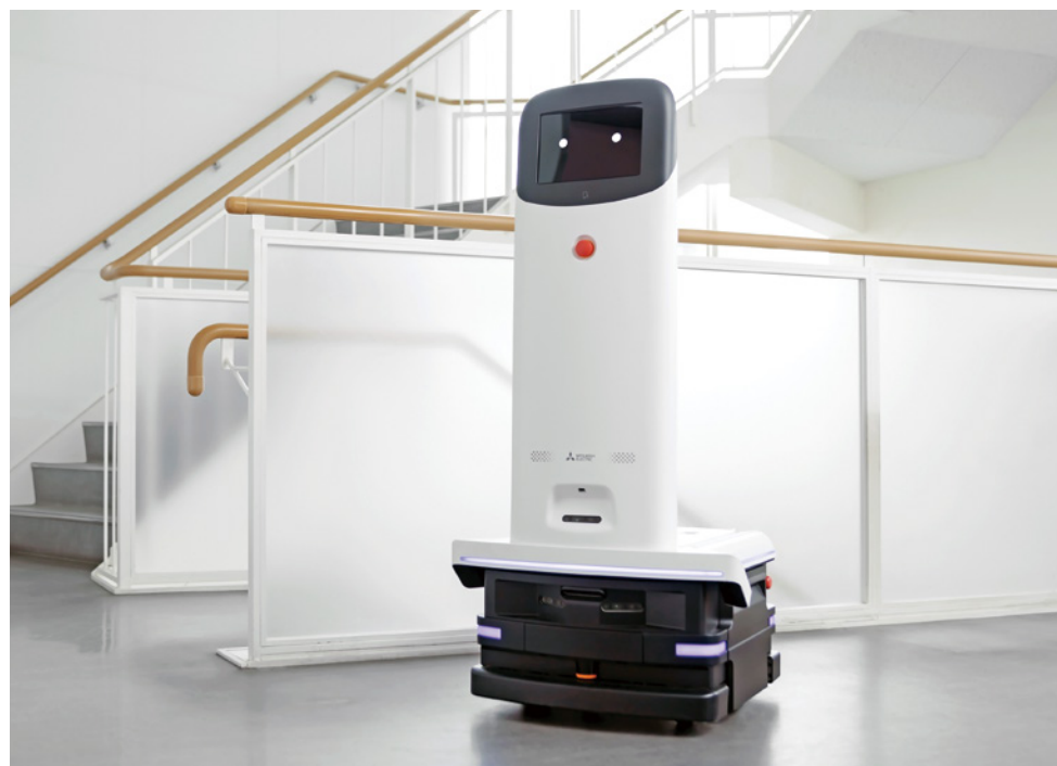
自動車機器事業部に新設されたモビリティ未来イノベーションプロジェクトグループと協働で開発に取り組んだ院内搬送ロボット「MELDY」。
